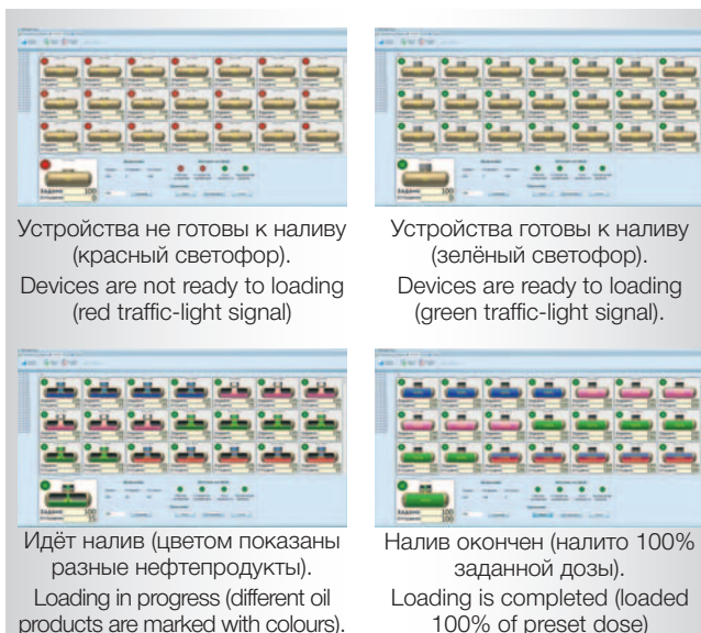
Вид экрана АРМа в разных фазах управления наливом. View of AWKS screen at different loading control stages
