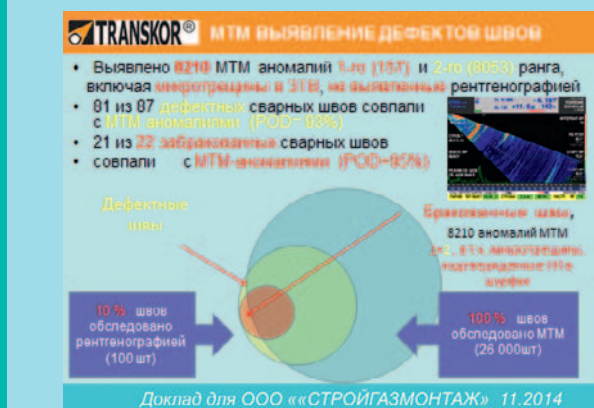
Рис. 1. Эффективность выявления микротрещин сварных швов газопровода в ходе «нулевой инспекции»
